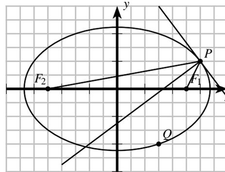
Daraus folgt, dass Strahlen, die den Gesetzmäßigkeiten der Optik folgen, von einem Brennpunkt der Ellipse in den anderen reflektiert werden, worauf einige Anwendungen basieren.
